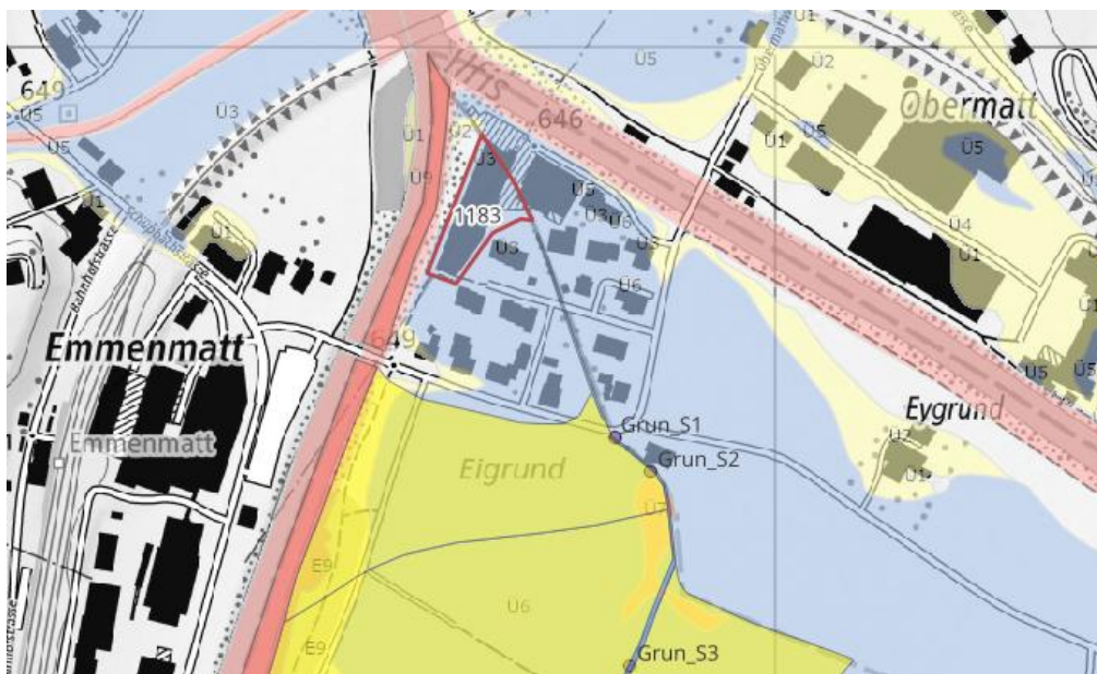
Abbildung 7: Ausschnitt Wassergefahren aus [1]. Die Lage der Parzelle 1021 ist rot umrandet. Die Gefahrenflächen der Emme sind in kräftigeren Farben überlagert.
